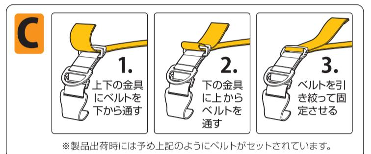
スクーターシートの厚みに合わせてJフックベルトの長さを調整 (厚みのあるシートは長く、薄いシートは短く設定)
